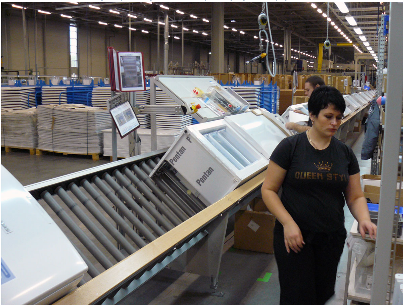
Наклонный двустворчатый рольганг для транспортировки корпусов холодильников
